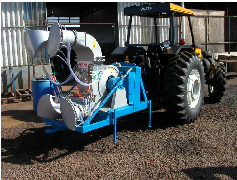
Figura 1. Turbopulverizador pneumático modelo Whirlwind B612 “Autonom-Trac” com quatro difusores de 90^\circ , sem tanque. Campos Gerais, MG. Safra: 2007/2008.
