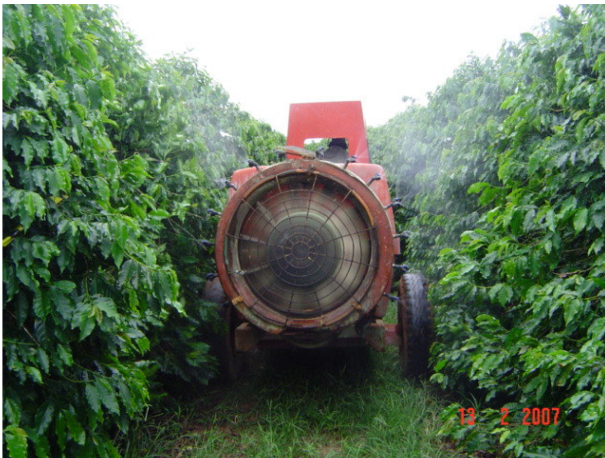
Figura 2. Turbopulverizador convencional utilizado em cafeeiro, com seis saídas duplas abertas em cada lado do ramal do pulverizador. Campos Gerais, MG. Safra: 2007/2008.
