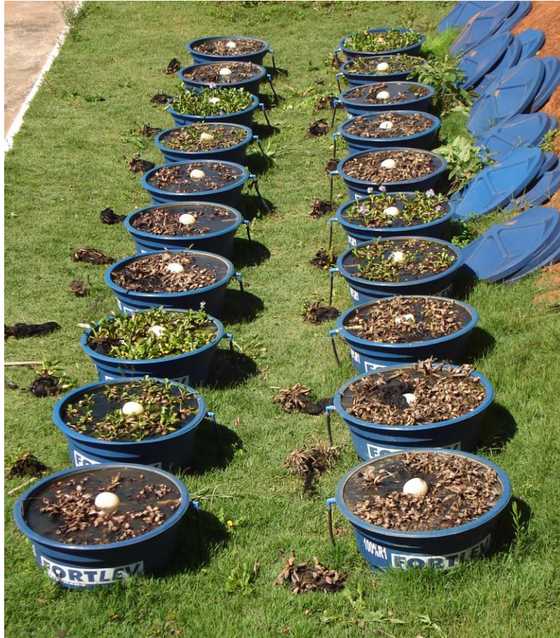
Figura 6: Parcelas do experimento de tratamento de água residuária com uso de aguapé em caixas de 150 litros (ARQUIVO PESSOAL).
