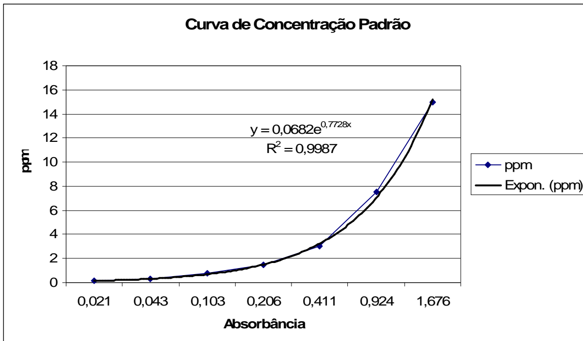
Figura 1 – Curva de leitura de absorvância para inferir a concentração das amostras de calda de 300 e 600 L.ha -1 .
