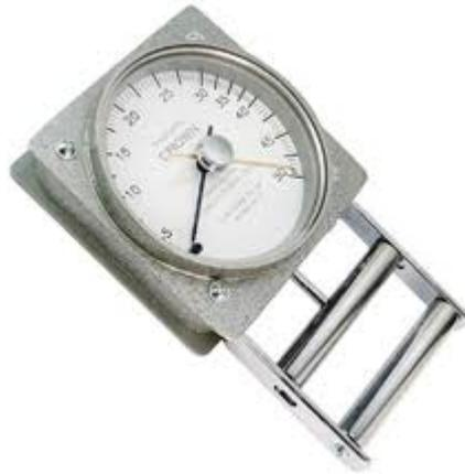
**Figura 4:** Dinamômetro manual(Dinamômetro Manual 50Kgf Crown)
