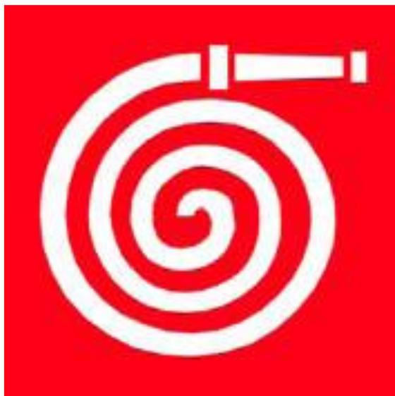
**FIGURA 15- Sinalização de equipamento para mangueira e hidrante**
