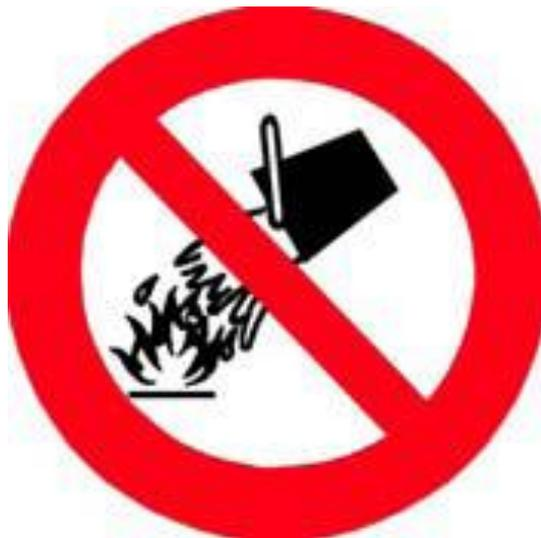
**FIGURA 12- sinalização de proibição de água para apagar o fogo**
