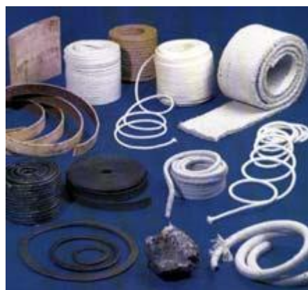
FIGURA 3 – Produtos feitos de amianto Fonte: www.proex.unesp.br . Acessado em 19/07/2009.
